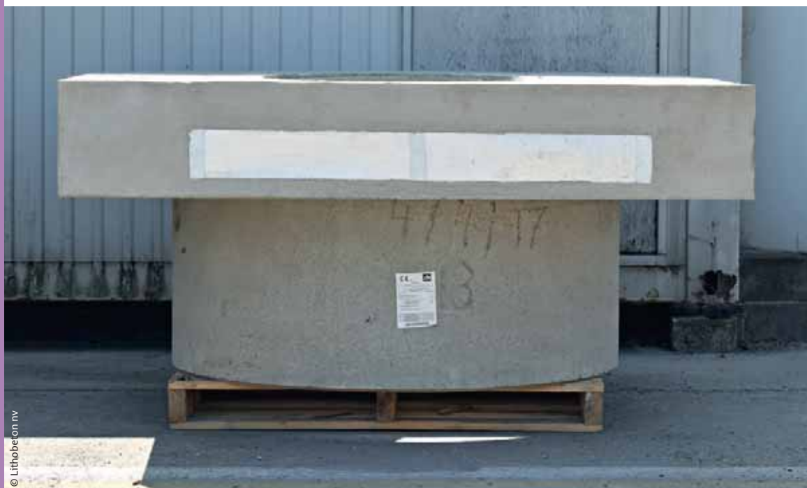
De proefopstelling van de zwevende dekplaat Le dispositif d'essai du couvercle flottant
